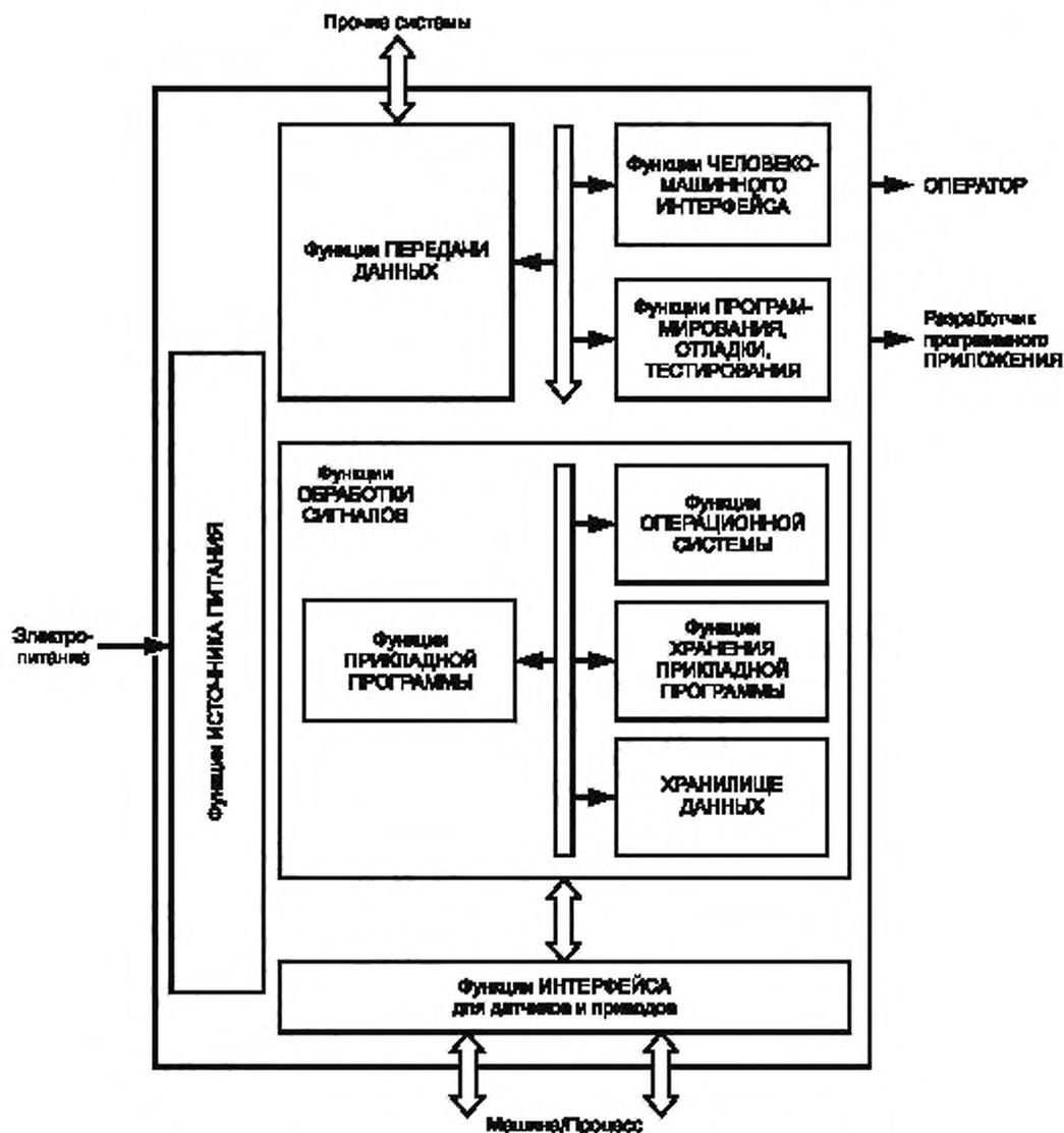
Рисунок 1 — Базовая функциональная структура ПЛК-системы
