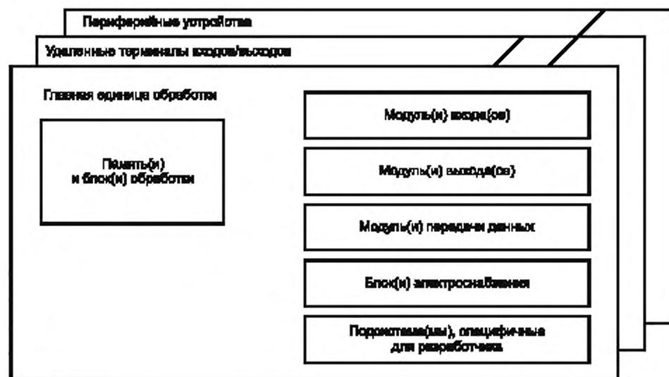
Рисунок 2 — Модель аппаратного обеспечения программируемого контроллера (по МЭК 61131-5)
