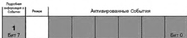
Рисунок A.23 — Структура Кода состояния типа 2
