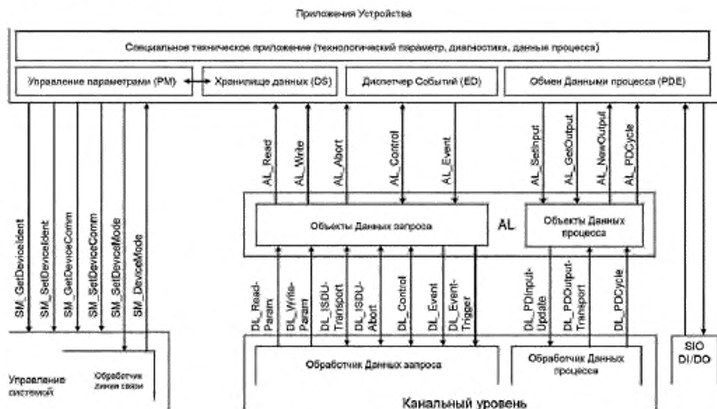
Рисунок 56 — Структура и услуги AL (Устройство)
