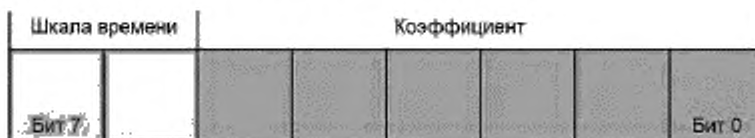
Рисунок В.7 — Структура параметра OffsetTime
