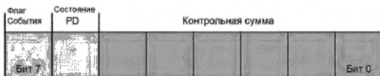
Рисунок A.3 — Октет контрольной суммы/состояния
