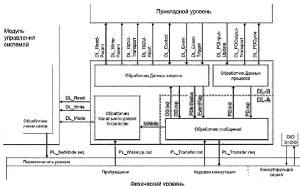
Рисунок 27 — Структура и услуги DL (Устройство)
