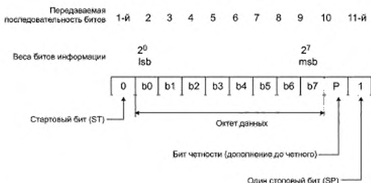
Рисунок 18 — Формат фрейма UART в технологии SDCI
