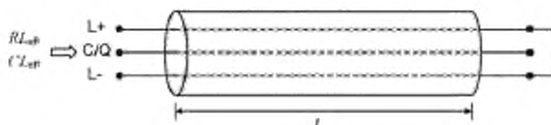
Рисунок 25 — Схема измерения эффективной емкости линии и сопротивления шлейфа
