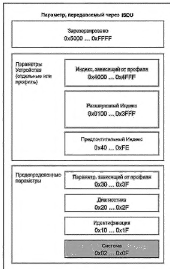
Рисунок В.6 — Индексное пространство объектов данных ISDU
