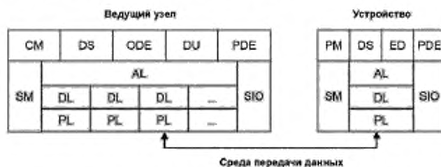
Рисунок 8 — Логическая структура Ведущего узла и Устройства
